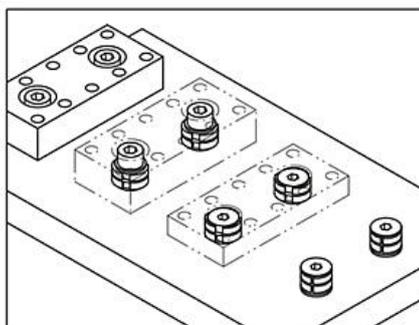
Para una alta precisión de reproducibilidad, la pieza de trabajo debe situarse sobre el dispositivo de posicionamiento. La operación de sujeción se realiza mediante la brida de centrado.
