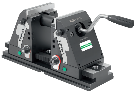
Mordaza de sujeción (roja) abierta en un lado -> Uso como tornillo de banco
