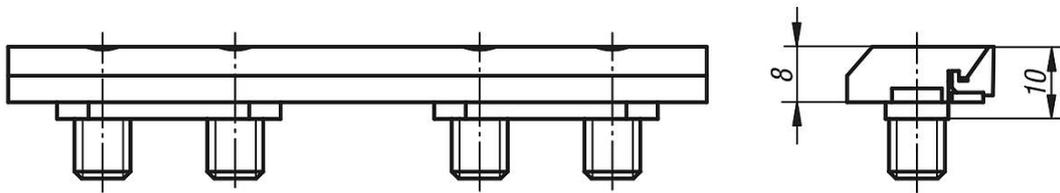
Tornillo de cabeza cilíndrica DIN 6912 M8x12 8.8
