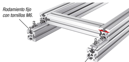
Rodamiento con apoyo libre con tornillos M5. Los perfiles se pueden mover lateralmente entre sí.
