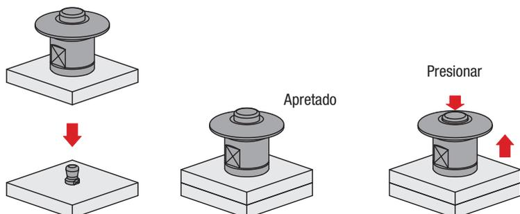
Colocar el cierre de tensión de presión sobre el perno de sujeción sin presionar el botón, de esta manera se fija el cierre de tensión de presión.
