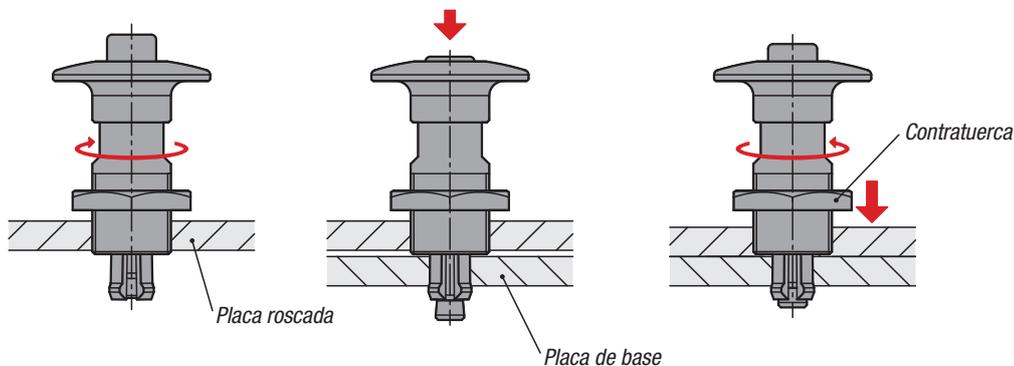
Girar el perno de bloqueo en la placa roscada hasta que se pueda ver la rosca por el otro lado.
