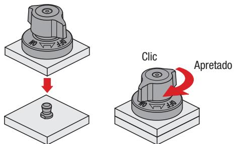
Comprobar que el botón giratorio está en la posición „OFF“. Colocar el cierre de tensión de torsión sobre el perno de sujeción y girar el botón giratorio a la posición „ON“. Cuando se cierra totalmente se oye una señal de clic.
