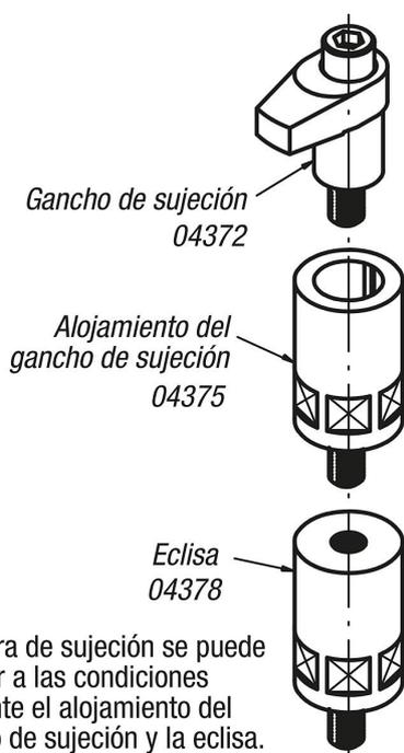
La altura de sujeción se puede adaptar a las condiciones mediante el alojamiento del gancho de sujeción y la eclisa.
