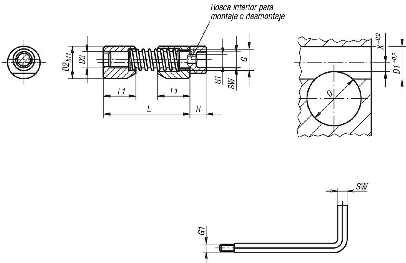
Destornillador especial de 6 kt con vástago roscado. Se enrosca en la rosca G1 del tornillo de cabeza cilíndrica para colocar o soltar el elemento de sujeción cilíndrico.
